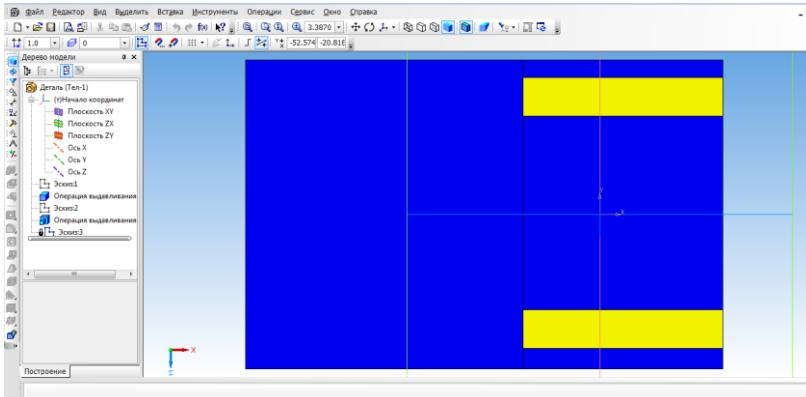
Выбрать **прямоугольник** типа: по центру и вершине. С помощью выравнивания осуществляем привязку к центру координат и середине стенки. Строим **прямоугольник** на всю ширину верхней грани. Закрываем эскиз.
