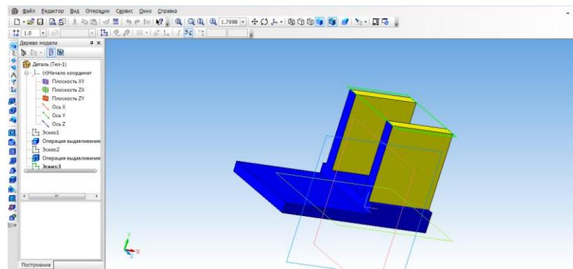
Выбрать операцию выдавливание (параметры: прямое направление, на расстоянии 3 мм, на вкладке свойства выбрать цвет крыши)
