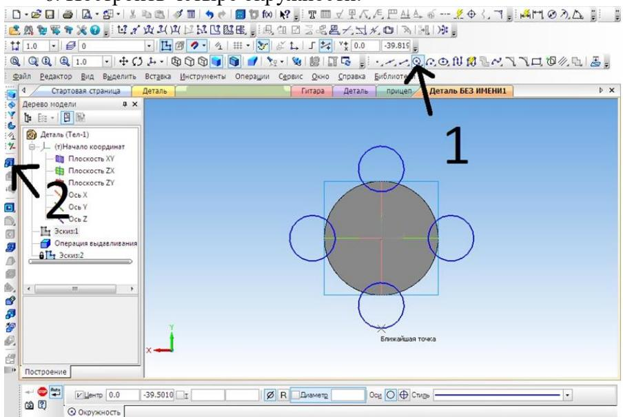
7. Выбрать операцию **Выдавливание** (параметры: расстояние1 – 40 мм, угол1 – 0 мм, расстояние 2 – 60 мм, угол2 – 8 мм)
