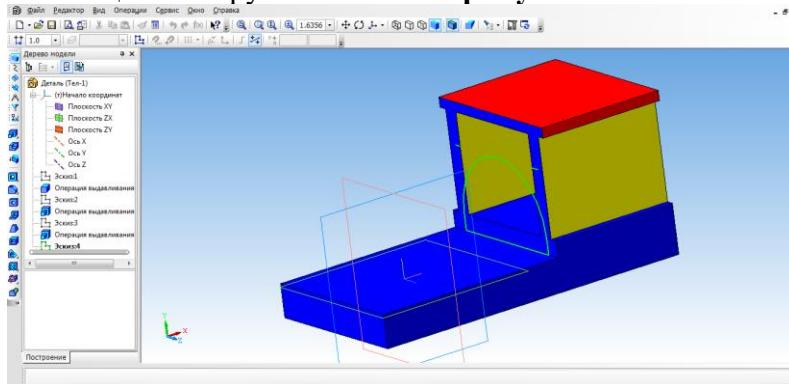
С помощью **Операции выдавливание** (параметры: прямое направление, на расстоянии 55 мм).
