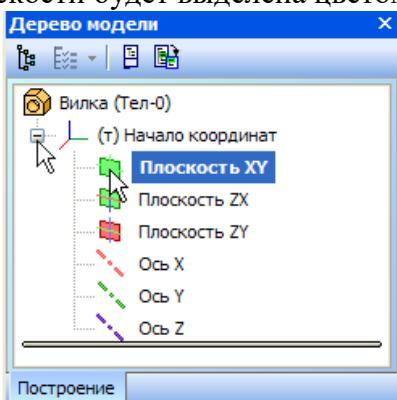
Нажмите кнопку **Эскиз** на панели **Текущее состояние**. Система перейдет в режим редактирования эскиза, **Плоскость XY** станет параллельной экрану.
