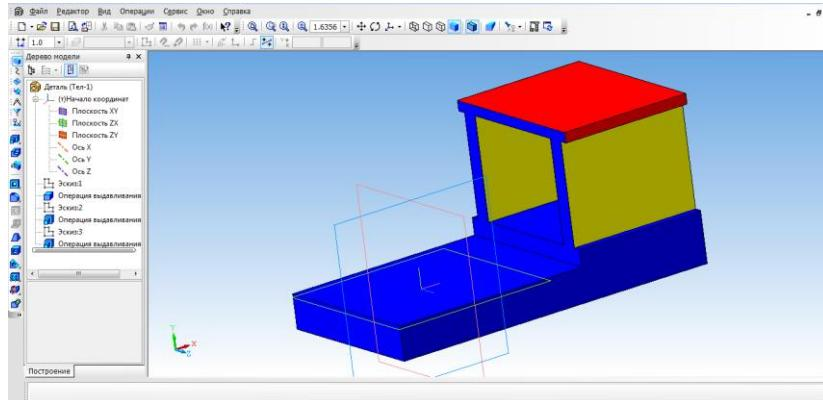
Создаем топливный бак. Выбрать грань кабины. Для начала необходимо создать проекцию. Выбрать инструмент **Спроецировать объект** и создать проекцию ребра.
