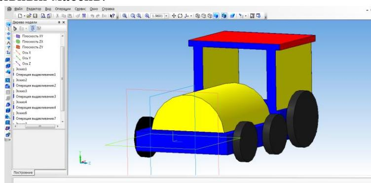
Создаем имитацию колеса. Выбираем грань одну из колес, переходим в режим **Эскиз**.
